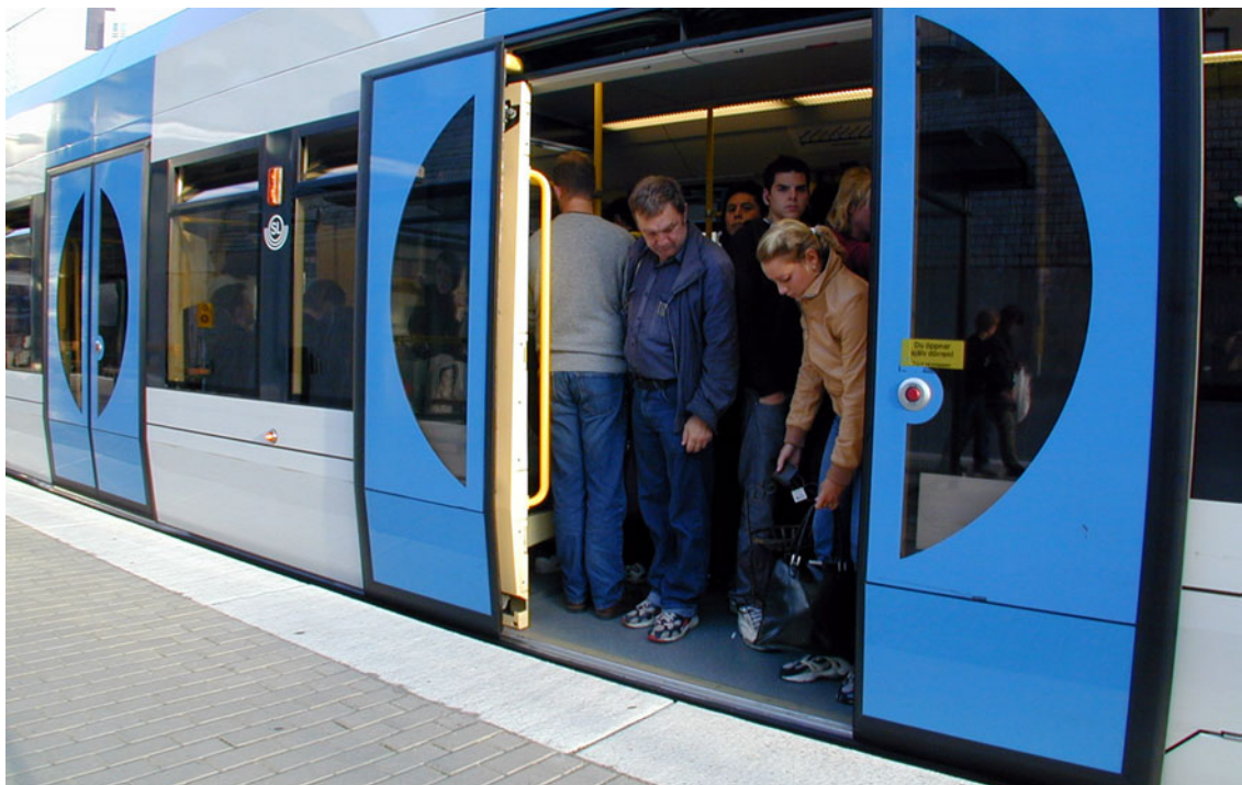
En meget lille afstand imellem perron og dørtrin. (Tvärbanan i Stockholm).
